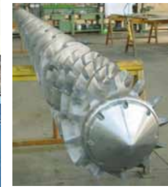
Vite da 350 mm Ø per espansi 350 mm Ø screw for foam polymers
