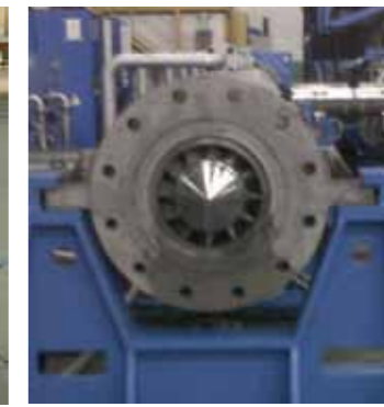
Cilindro e vite da 350 mm Ø per espansi Barrel and 350 mm Ø screw for foam polymers
